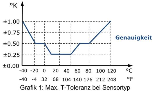
**Temperatur und Feuchtigkeit für RH Fühler bei -HT-Typ**
