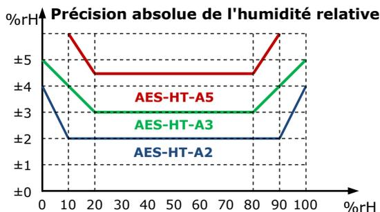
Figure 1: Max. RH-tolérance à 25 °C (77 °F) par type de sonde.
